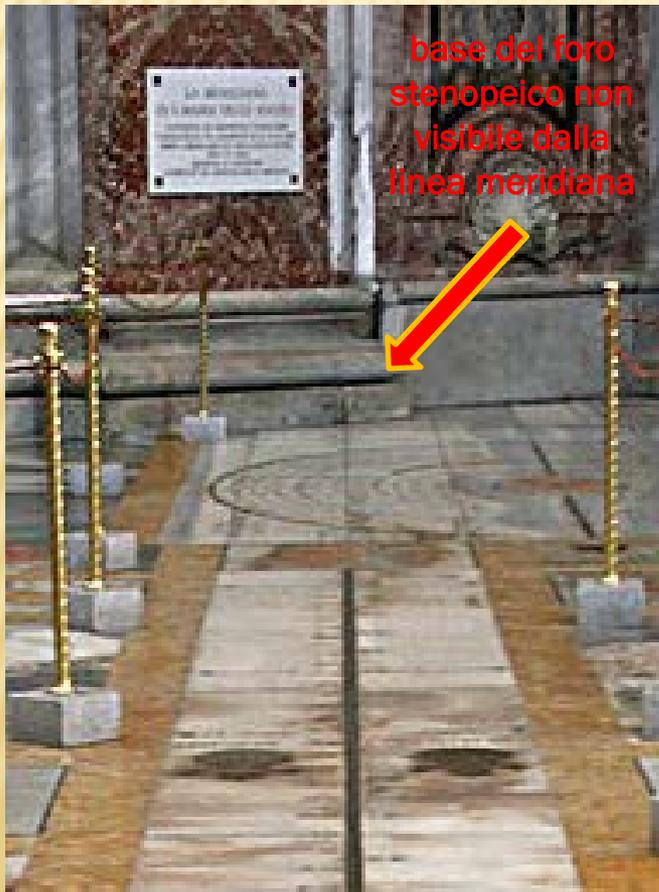
Posizionando lo strumento di rilievo lungo la linea meridiana non risulta visibile la base del foro stenopeico (proiezione a terra della verticale passante per il foro). Bisogna dunque effettuare una stazione esterna alla linea meridiana, che ci consenta di vedere contemporaneamente la base del foro, il foro stesso, ed un altro punto della linea meridiana (in questo caso abbiamo scelto l'estremo opposto)
